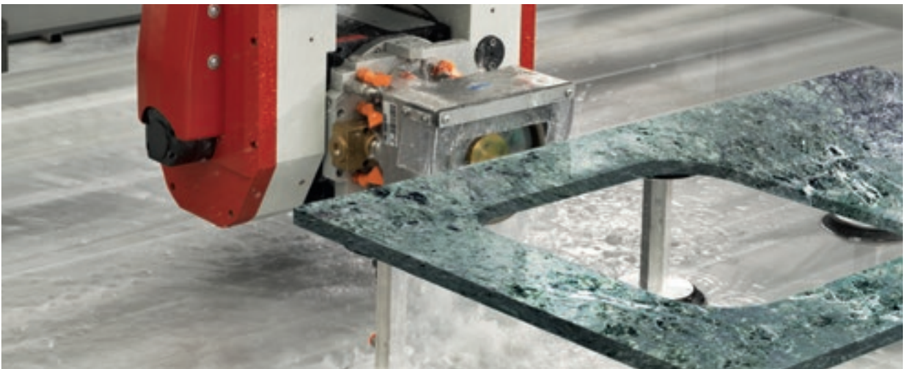
Desbaste tipo copo da aresta externa.
