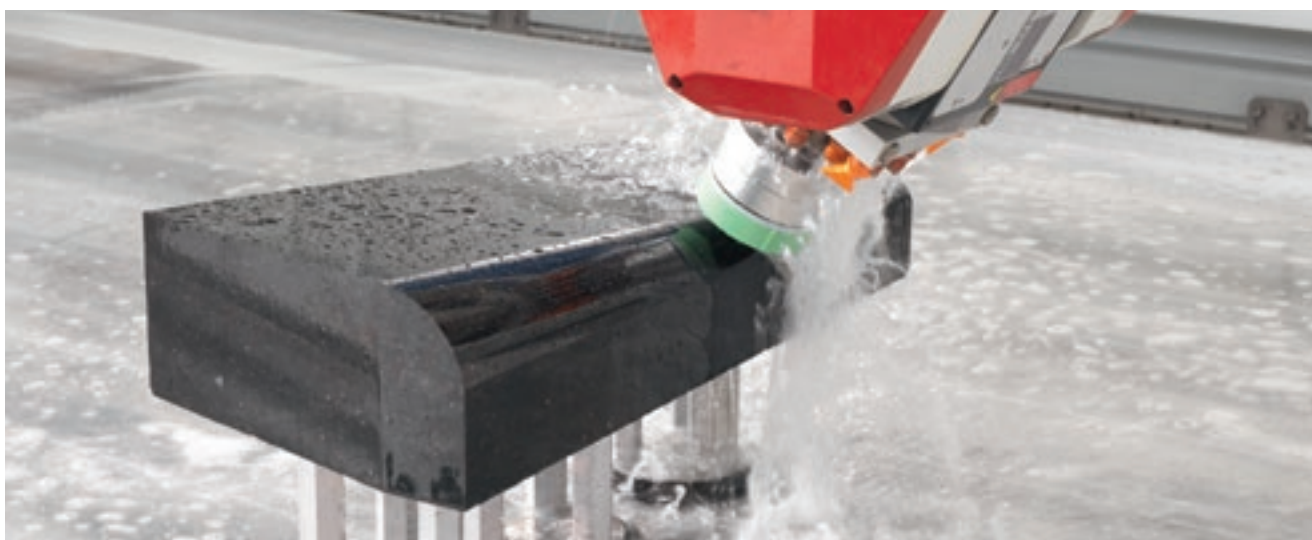
Polimento de perfis arredondados em blocos.
