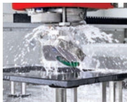
Corte com disco a 45° para uniões.
