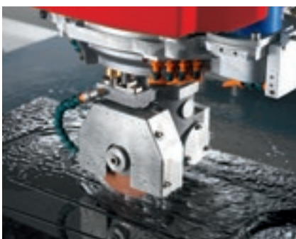
Canaletas de drenagem sobre superfície inclinada para bancada de cozinha.
