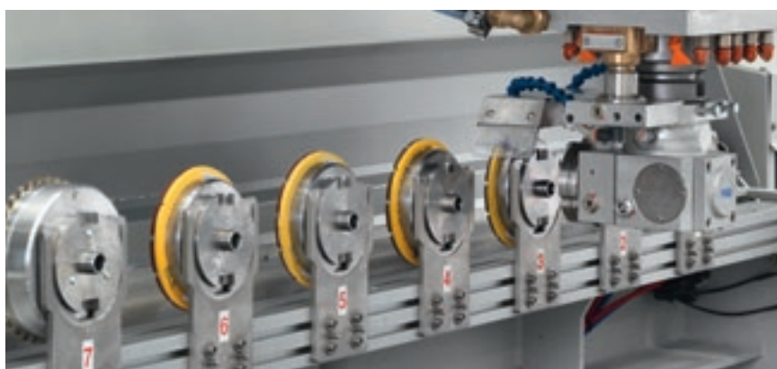
Depósito específico para a troca de ferramentas para agregado com troca magnética.
